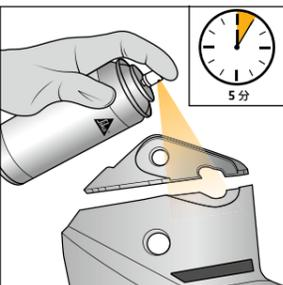
■ 両側にプラスチックプライマーを薄くスプレーし、5分間<sup>1)</sup>乾燥させる
