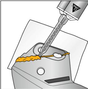
■ 更に破損箇所<sup>1)</sup>に接着剤を塗布する
