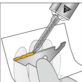
■ 成型フィルムを破損したプラスチック片に添えてプラスチック用超速硬化接着剤を塗布する
