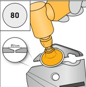
■ 断面がV字溝(約1cm幅)になるように、80番手のサンドペーパーを用いて研磨する
