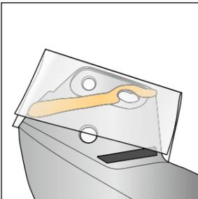
■ フィルムを折り曲げ、接着剤を圧着し、製品ラベルの通り硬化時間まで待つ
