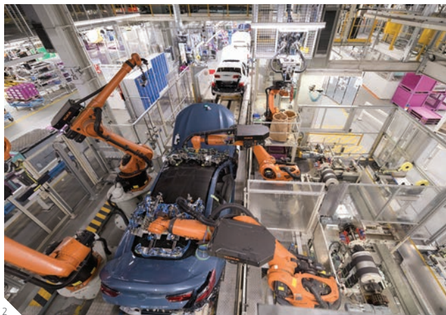
1 Sikaflex®の自動施工 2 フロントガラスの自動接着
