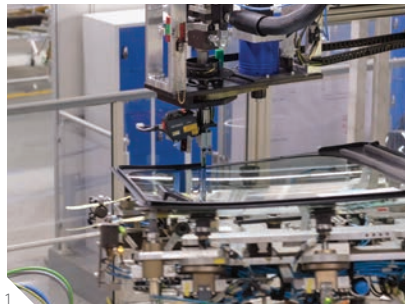
1 Sikaflex®の自動施工 2 フロントガラスの自動接着
