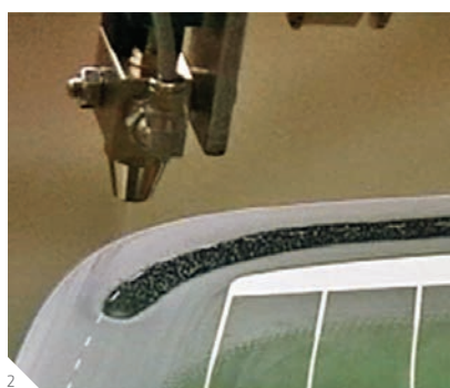
1 ガラス、セラミック、塗装面、プラスチックに対応する「オールインワン型」黒色プライマー、SikaPrimer®-217LUM 2 水性接着促進剤、Sika®Primer-217 LUMの自動施工
