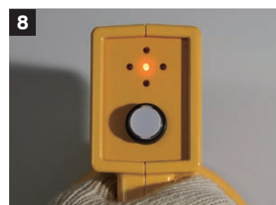
加熱終了(センターライトのみ点灯)
