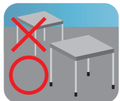
接地面にパイプ状のイスやテーブルを置く場合は、脚先をゴムキャップ等でカバーしてください。
