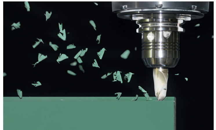
切削加工性に極めて優れ、 粉塵が発生しにくい SikaBlock® M945
