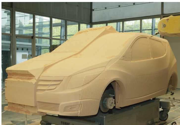
SikaBiresin® B260接着剤を使用してSikaBlock® M330ボードで製作されたフルスケールの自動車モデル
