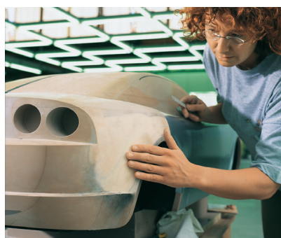
SikaBlock® PROLAB 65 Nから切削加工された、最も厳しい表面品質の要件を満たすモデル
