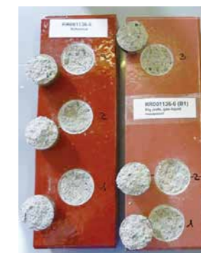
付着強度測定 いずれもコンクリート下地からの凝集破壊：左：初期試験体、右：促進試験後の試験体
