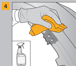
■ Sika® Cleaner G+Pで表面を清掃し、水分が残らないよう乾燥させる
