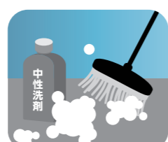
防水層を清掃する際は、中性洗剤以外は使用しないでください。モップ等のやわらかい清掃用具で行ってください。
