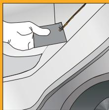
11 ■ 接着したパネルの継ぎ目の外側をシールするため、はみ出した接着剤を均します。
