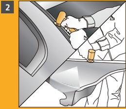
2 ■ 車体と新しいパネルの両方の接着面を金属素地ができるまで研磨してください。
