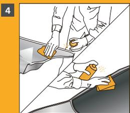
4 ■ 残留物が残らない適切な溶剤で接着面を脱脂してください。
