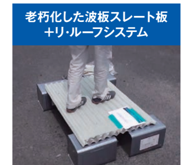
老朽化した波板スレート板 +リ・ルーフシステム 両足が乗っても破損せずまた、屈伸しても破損せず
