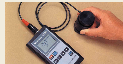
シートに特殊加工が施されており、探触子を接地するだけでウレタン塗膜を傷つけることなく膜厚を測定できます。（渦電流式膜厚計）
