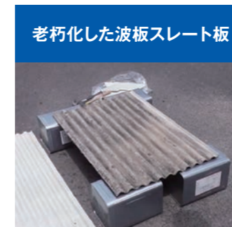
老朽化した波板スレート板
