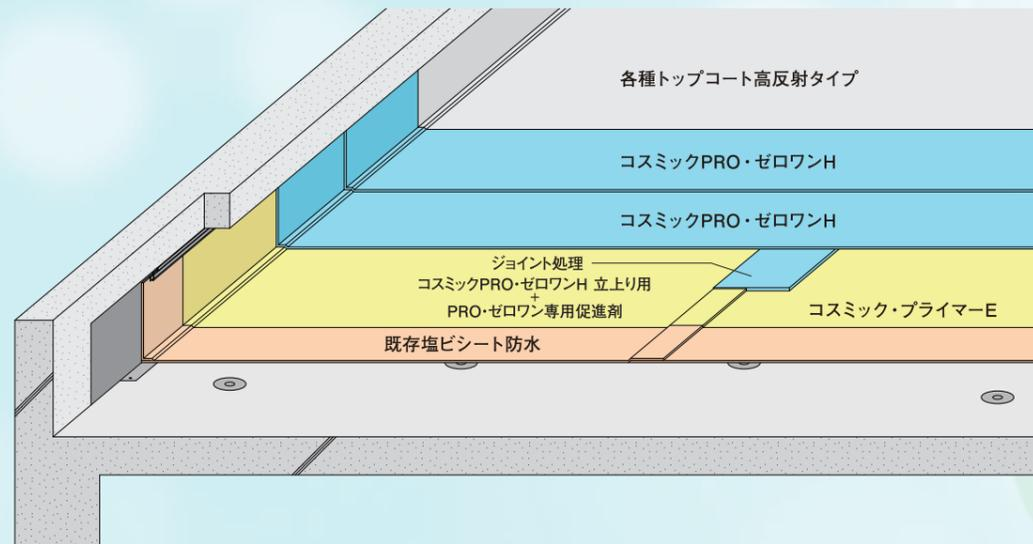
※既存塩ビシート防水の状態によってはジョイント部や機械的固定工法のディスク盤部にメッシュ補強が必要になります。
