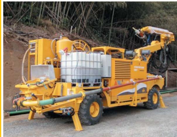
急結剤タンクを搭載した吹付け機
