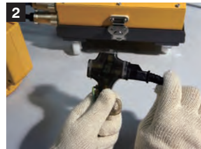
2 電源ON(電源ON/OFFスイッチはありません。コンセントにつなぐだけです。)
