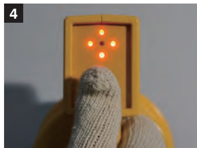
4 加熱作業前に、IWディスクから離れた場所で位置検知スタートボタンを押す(約1秒)
