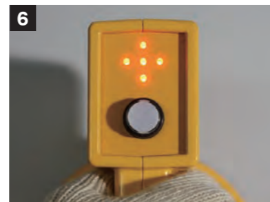
6 IWディスクのセンターを検知後、全てのライトが点灯し、自動で加熱開始(同時にシート表面温度を測定し加熱秒数を自動で決定)
