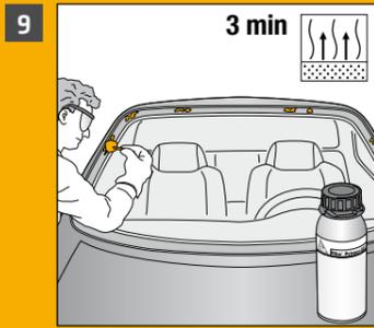
■ 取り外し中にできた塗面の小さなキズはSika®Primer-207でタッチアップを行ってください。大きなキズはボディショップに相談するか、カーメーカーの補修マニュアルを参照してください。
