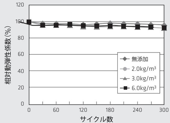
図-2 凍結融解抵抗性試験結果
