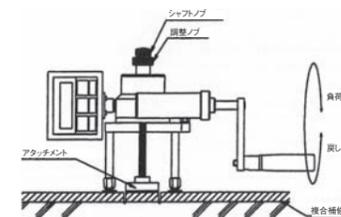
図3 複合補修層の接着強度試験
