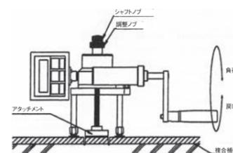
図3 複合補修層の接着強度試験
