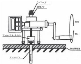
図1 アンカーピンの引抜き試験
