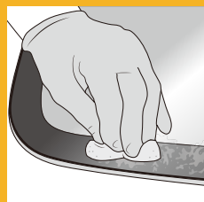
未使用 Sika®Cleaner PCA で 汚れを除去
