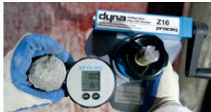
施工後6か月経過時の付着強度測定で2.0 N/mm 2 を維持
